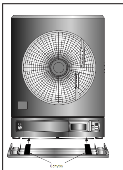
Obr. 2-4a. Instalace Víka Podstavce (Pohled Shora)
